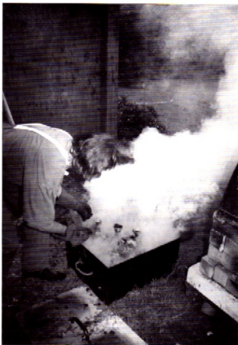
In dem geschlossenen Behälter hat eine „Reduktion“ stattgefunden, die bei der Farbgebung unterschiedliche Effekte hervorbringt.
